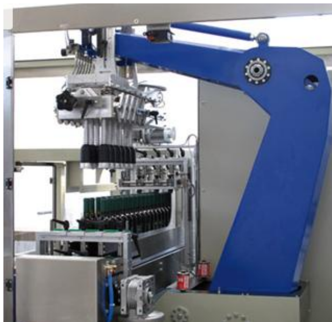
Рис. 8. Робот для укладання у картонні коробки компанії Італіан Ботлінг Пакинг Груп, (IBP GROUP SRL).
