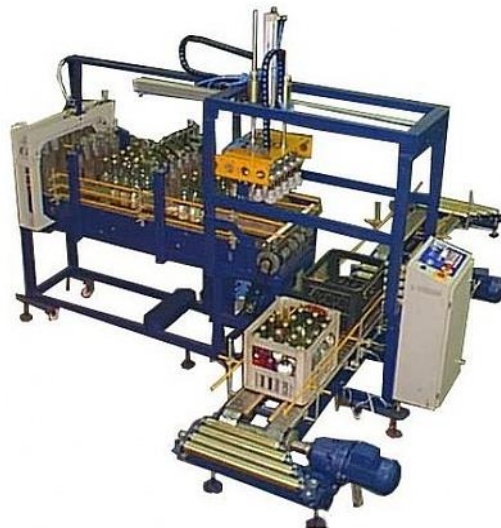
Рис. 3. Укладальник "УБЯ" призначений для автоматичного укладання пляшок , "ННХС" (Росія)
