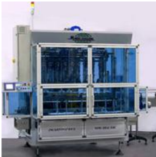
Рис. 5. Укладальник пляшок в коробки виробництва Mondo&Scaglione (Італія).
