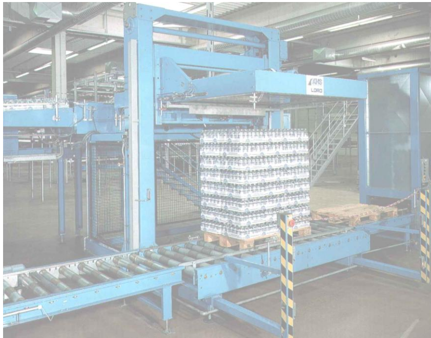
Рис. 12. Машина для виймання порожніх пляшок з ящиків
