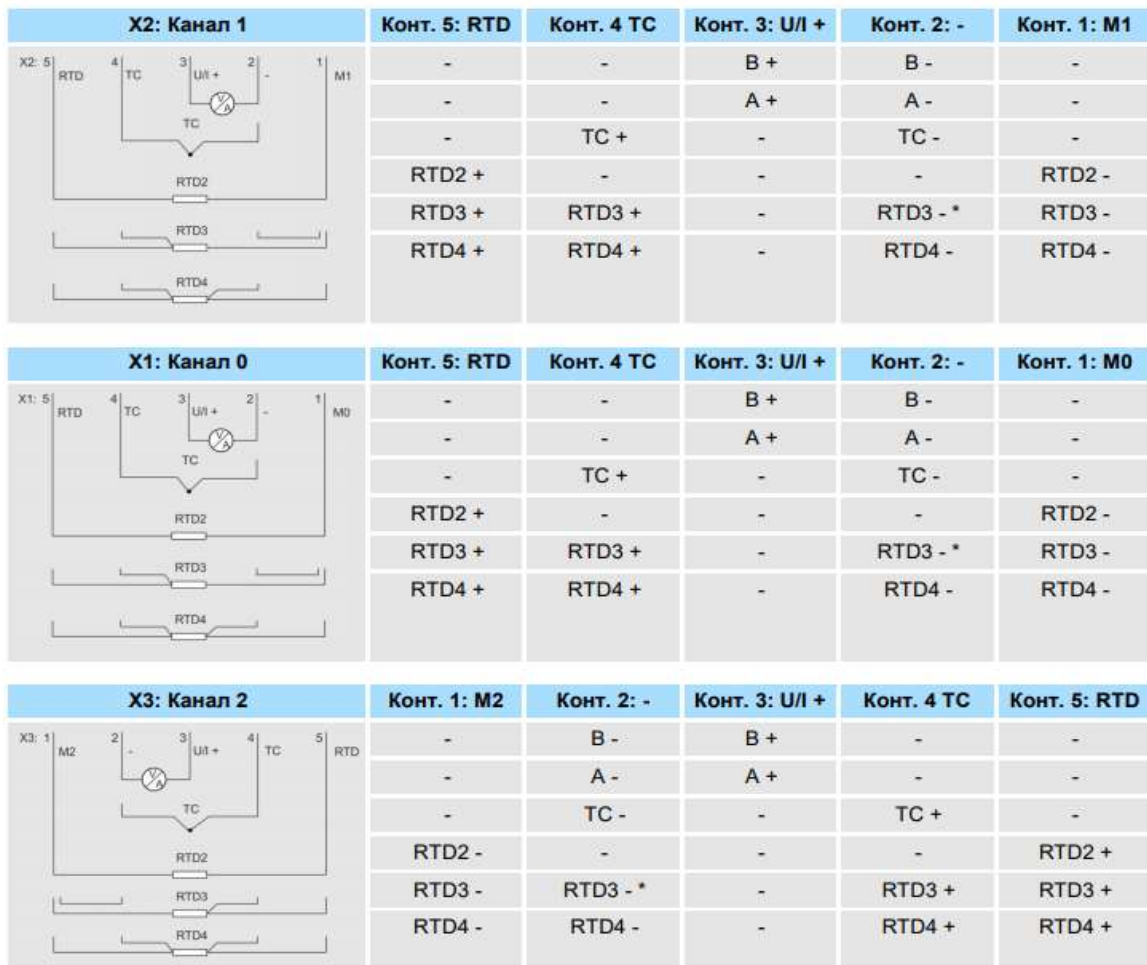
Рисунок 3.3.2 – Схема підключення різних типів датчиків до SM M31
