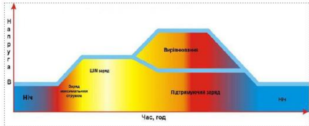
Рисунок 1.16 – Ілюстрація роботи акумуляторної батареї сонячної електростанції.
