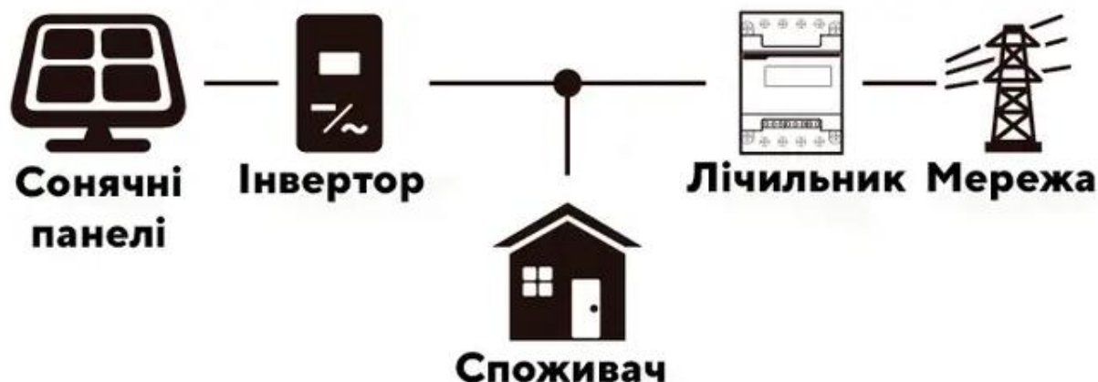
Рисунок 3.8. Підключення інвертора у схемі сонячної електростанції.
