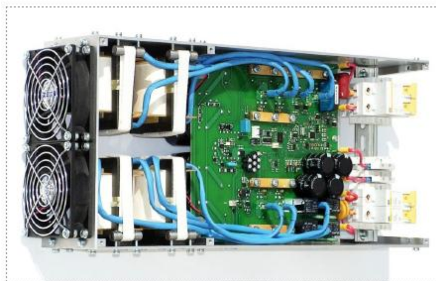
Рисунки 1.19, 1.20 – Приклади конструкції інверторів сонячної електростанції
