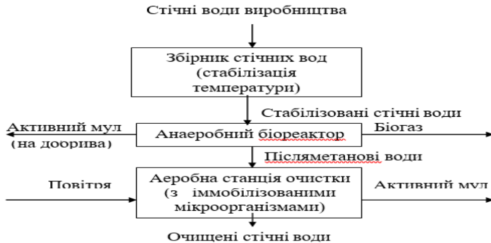
Рис.12.1 – Принципова технологічна схема двостадійної очистки стічних вод
