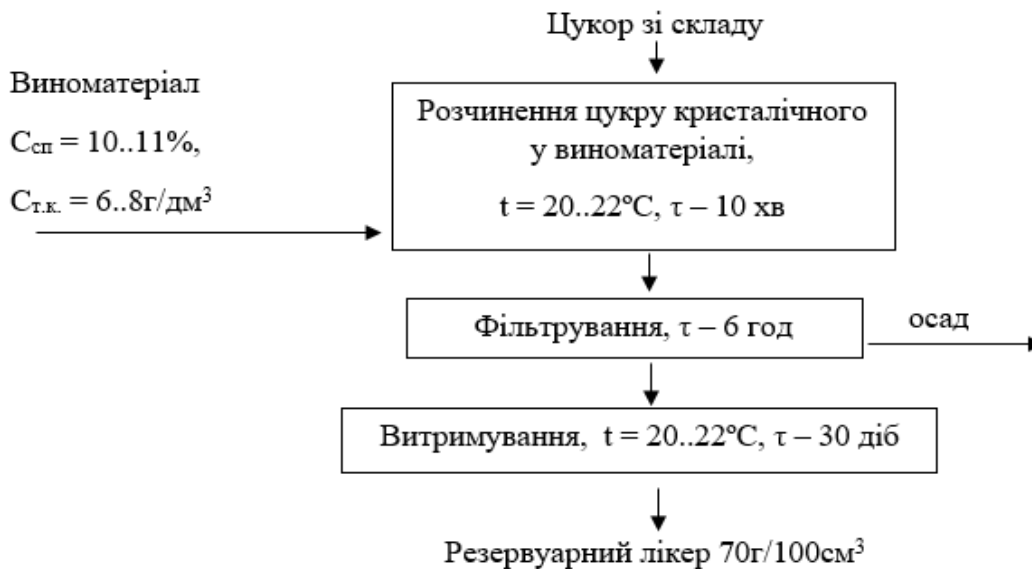
Рис. 2.3. Схема приготування резервуарного лікеру
