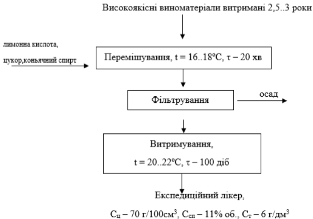
Рис.2.4. Схема виробництва експедиційного лікеру
