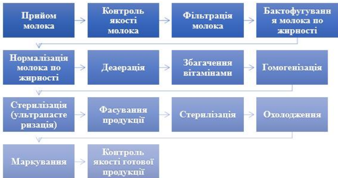
Рис. 2.11. Схема виробництва продукції філії ТДВ «Яготинський маслозавод» «Яготинське для дітей»
