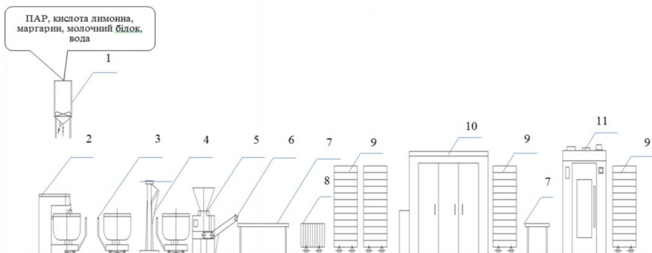
Рисунок 7 – Апаратурно-технологічна схема виробництва хлібобулочних виробів, збагачених молочними білками: 1 – диспергатор; 2 – тістомісильна машина; 3 – діжа; 4 – діжеперекидач; 5 – тістоподільник-тістоокруглювач; 6 – транспортер; 7 – стіл; 8 – технічний візок; 9 – контейнери; 10 – шафа остаточного вистоювання; 11 – піч ротаційна
