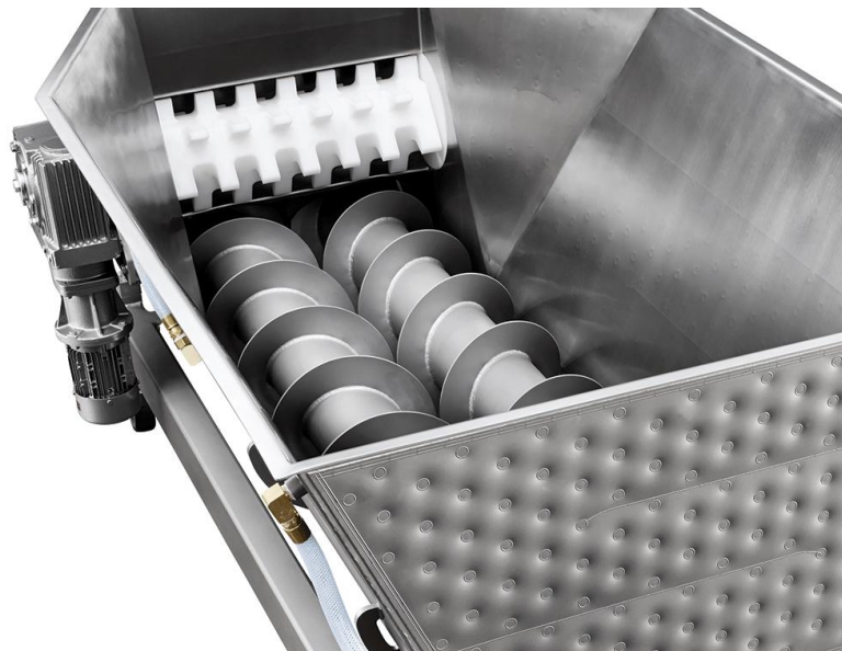
Рис. 2. ContiMix – безперервний екструдер-змішувач для тіста (Bühler)
