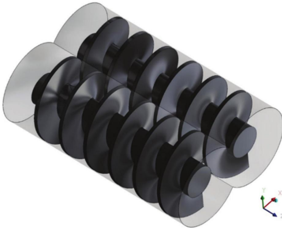
Рис. 8. 3D-модель робочого об'єму, імпортована в модуль ANSYS Meshing для подальшої дискретизації
