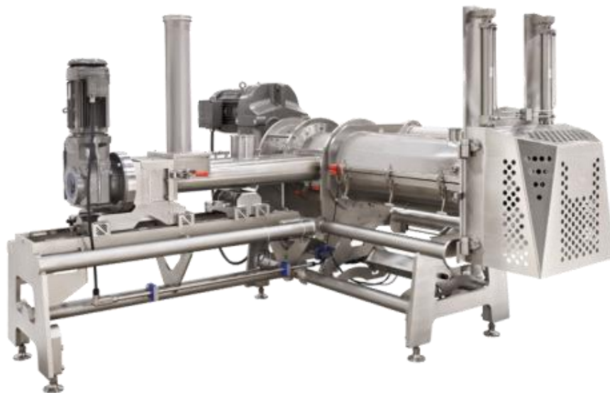
Рис. 3. HDX Continuous Mixer – безперервний змішувач для хлібного тіста (Exact Mixing)
