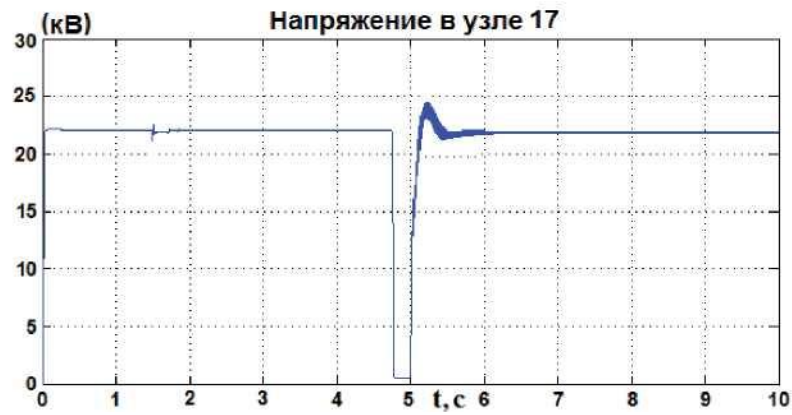
Рис. 3.48. Діюче значення напруги в вузлі 17 для сценарію V
