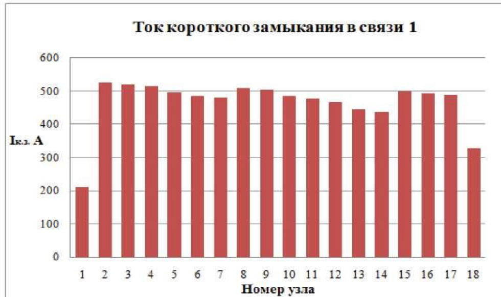
Рис. 3.3. Значення струмів в лінії 1 при КЗ в різних вузлах СЕР
