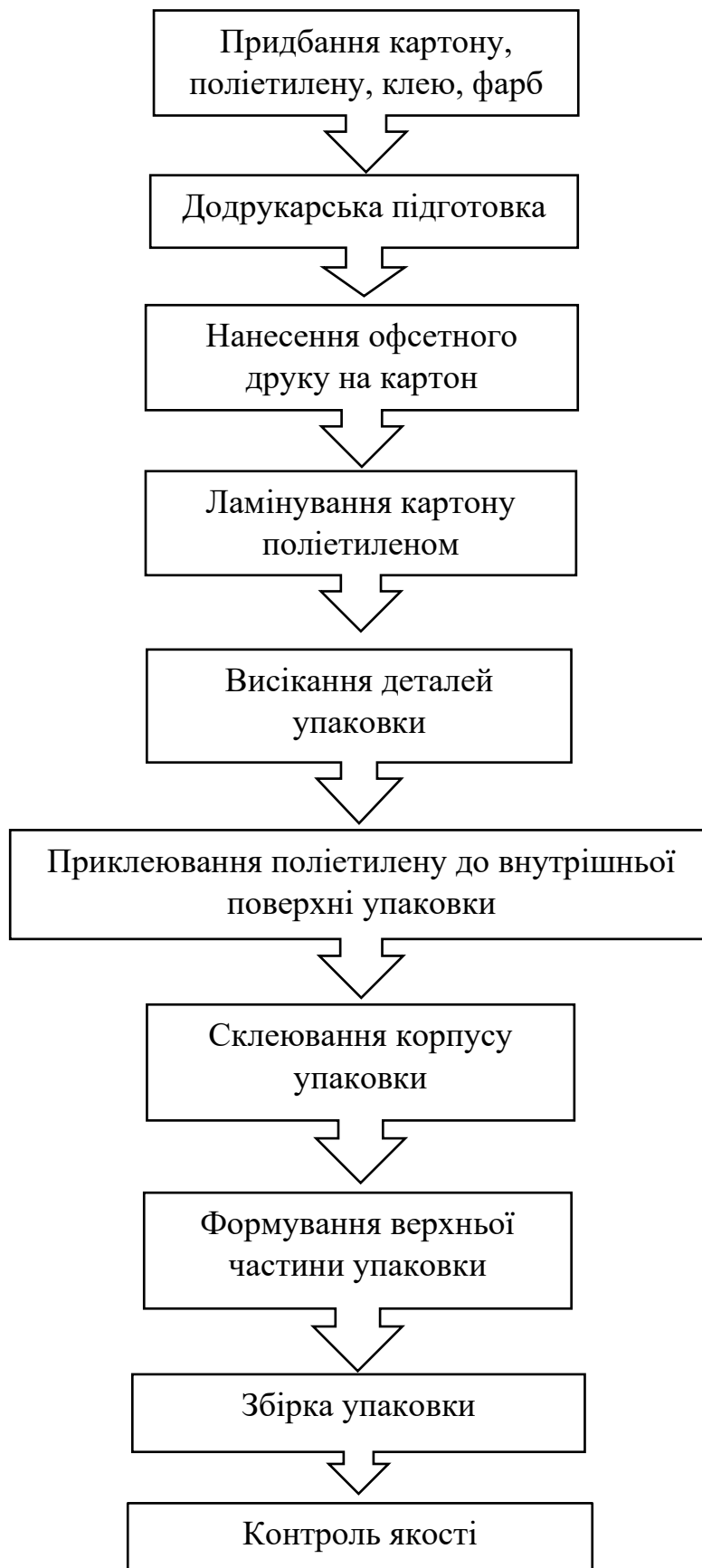
Рис. 4.1. Технологічна схема виготовлення упаковки
