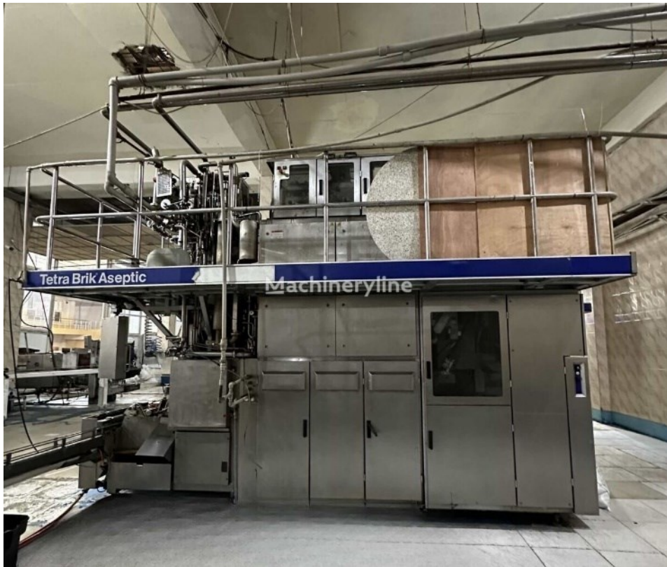
Рис. 4.9. Автоматизована пакувальна машина Tetra Pak® TBA/19
