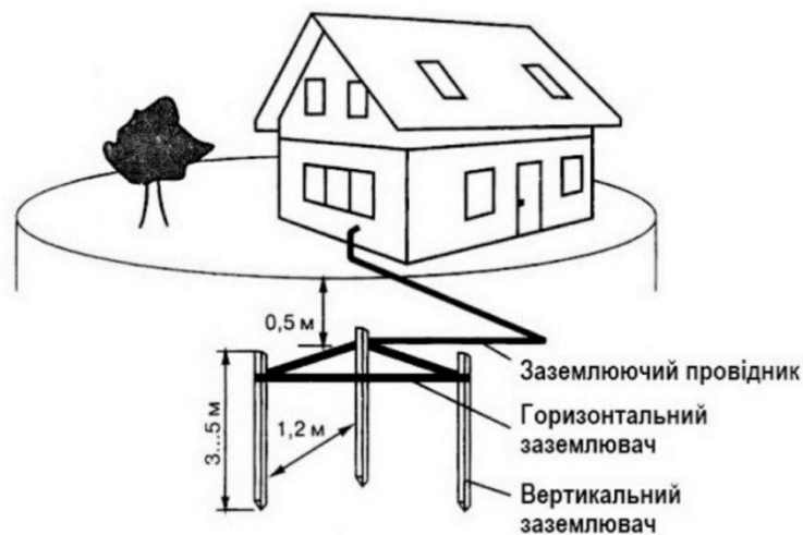
Рисунок 2.6 – Приклад розміщення земляних заземлювачів [19].
