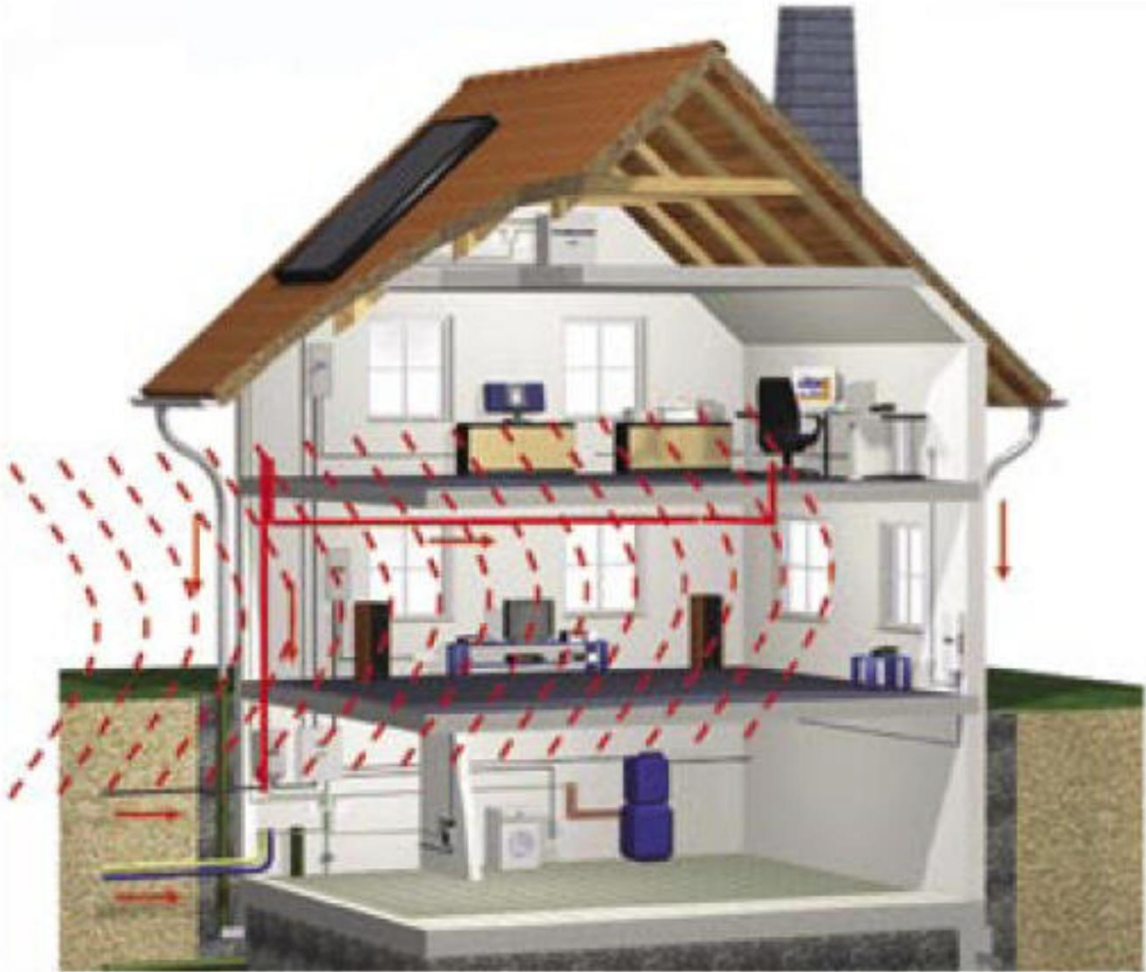
Рисунок 2.4 – Виникнення наведених імпульсів перенапруг у лініях електрокомунікації і провідних конструкційних елементах внаслідок близького розряду блискавки [9].
