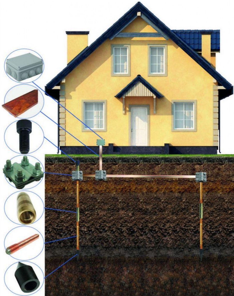
Рисунок 2.2 - Елементи контуру та необхідні матеріали [14].
