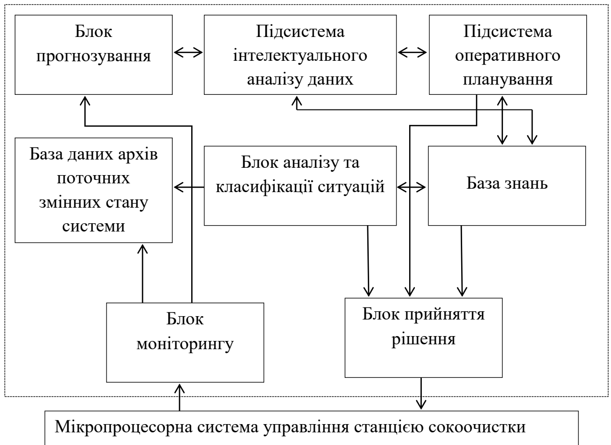
Рис. 3.4. Структура інтелектуальної системи керування відділенням дефекосатурації цукрового заводу.
