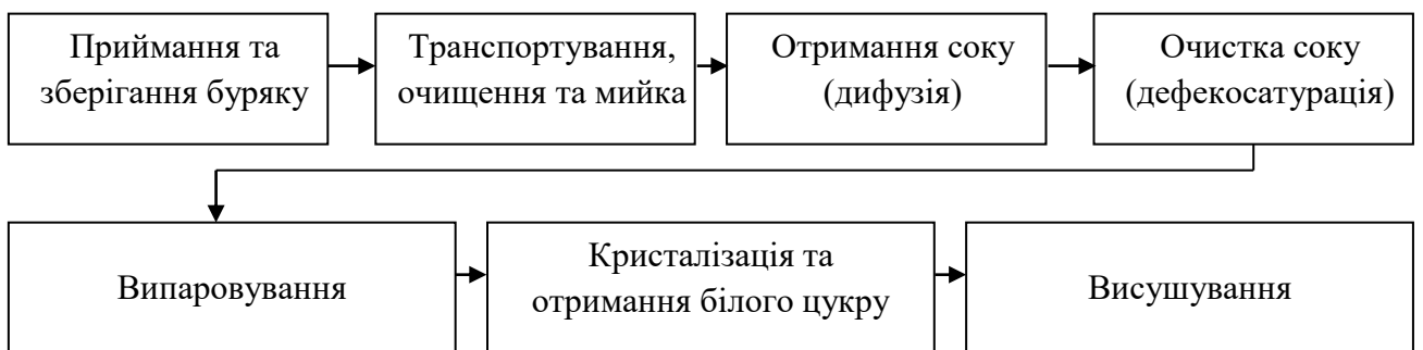
Рис. 1.1. Основні етапи виробництва цукру.
