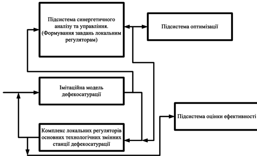
Рис. 3.8. Структура підсистеми імітаційного моделювання
