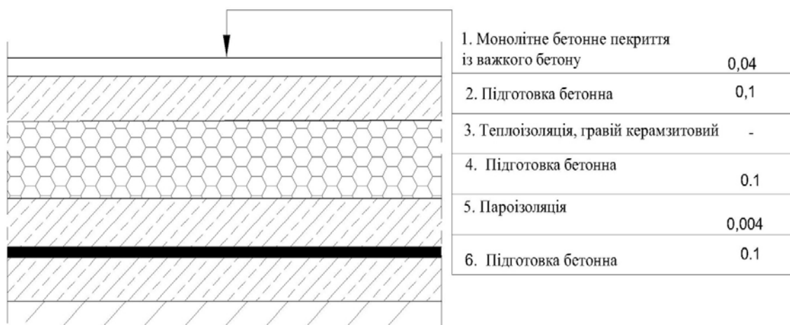
Рис. 4. Конструкція підлоги
