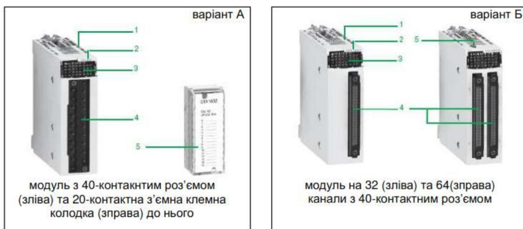
Рис. 2.14 Зовнішній вигляд дискретних модулів з різними варіантами підключення
