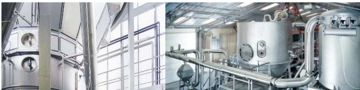
Рис. 3.2. Капельна сушилка молока Agrometal Klaster (Австрія). Джерело:
