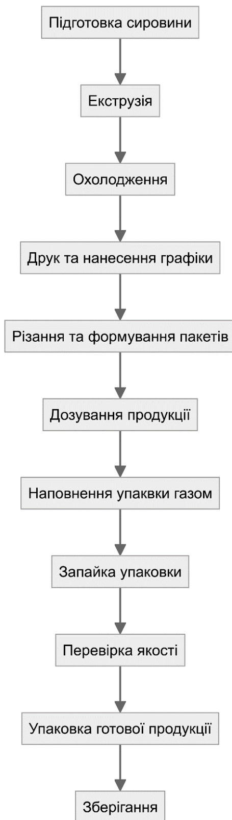
Рис. 4.1. Технологічна схема виготовлення упаковки
