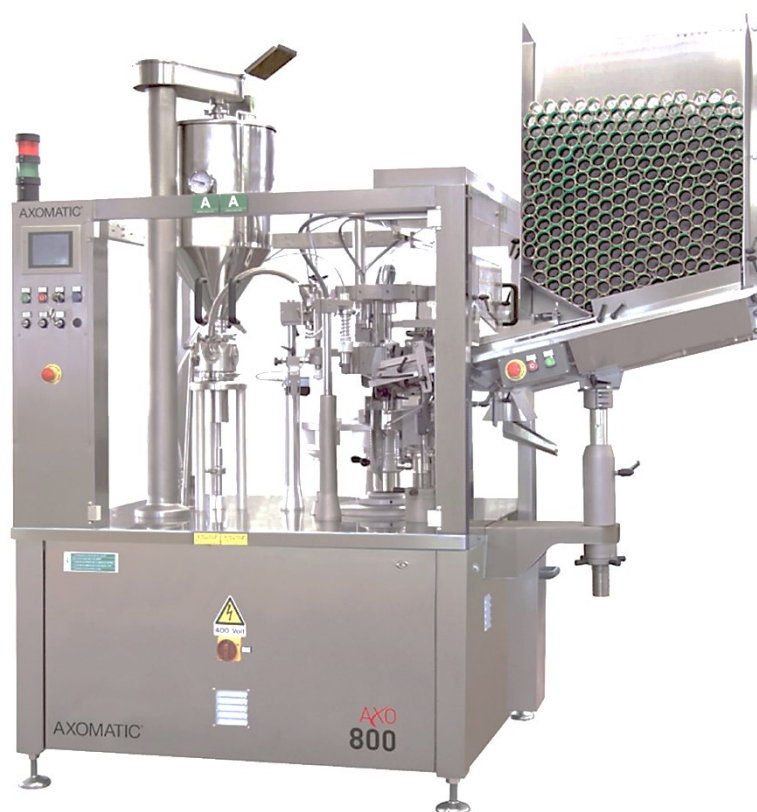
Рисунок 22 – Загальний вид тубонаповнюючої машини Axomatic Axo 800 (GVP Equipment Solutions) [99]
