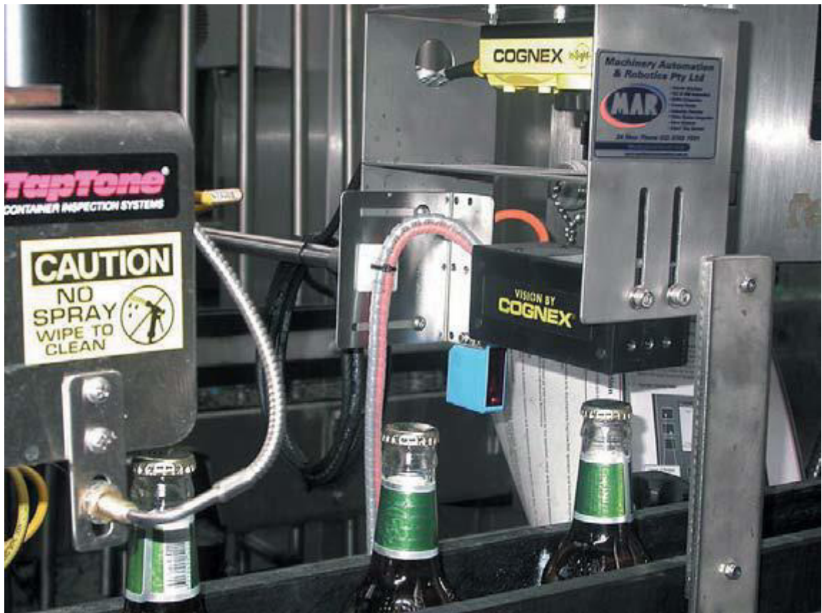
Рис. 1.6. Контроль наявності та положення пробки на плящі.
