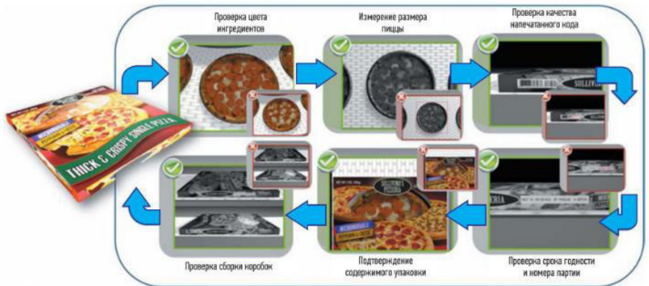
Рис. 1.10. Контроль процесса производства пиццы интеллектуальной камерой Cognex In-Sight.
