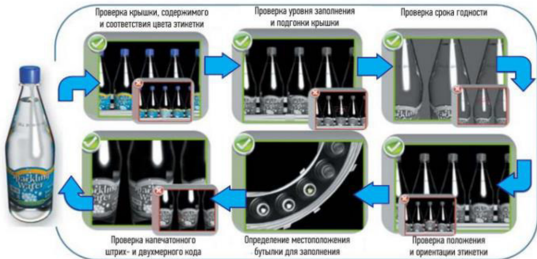
Рис. 1.11. Контроль процесу виробництва напоїв інтелектуальною камерою Cognex In-Sight.
