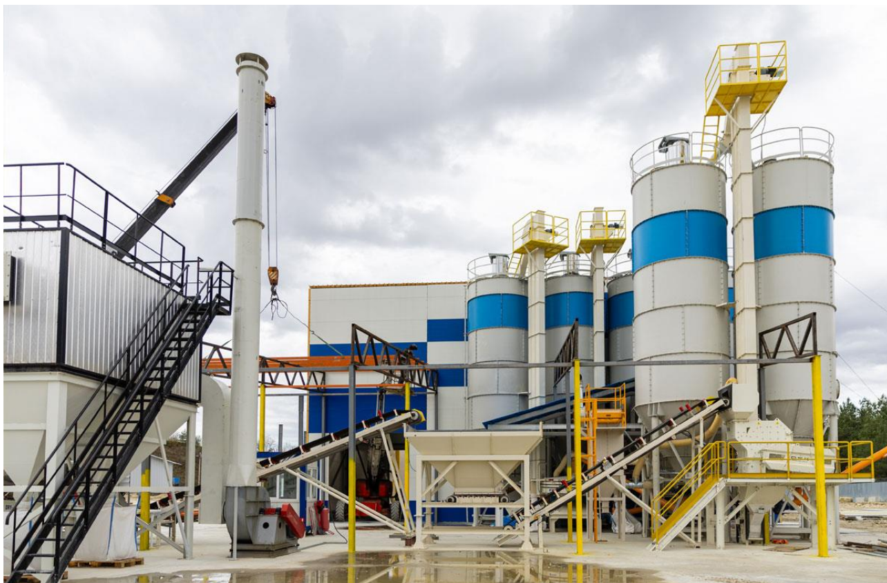
Рисунок 4.4 – Установка виробництва мінерального порошку RPM
