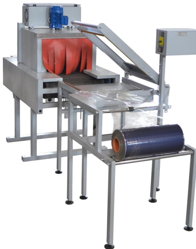
Рисунок 1.5 – Термотоннель с ручным L-образным запайщиком ТТ-5-Л
