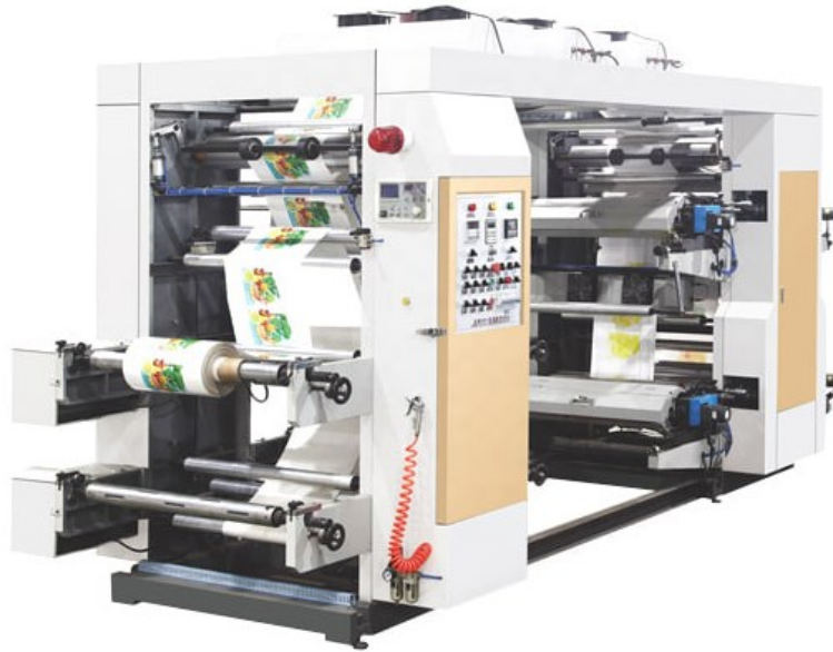
Рис. 4.1 – машина для флексографічного друку UTC2-1000.
