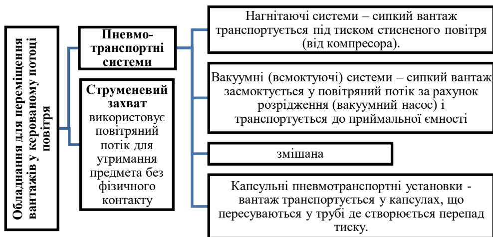
Рис.1. Класифікація обладнання для переміщення вантажів з використанням керованого потоку повітря
