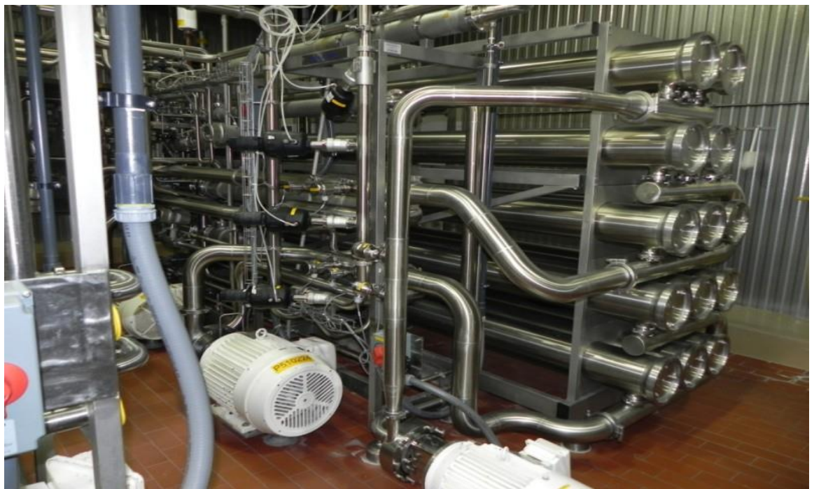
Рис.1.3. Приклад використання ультра фільтраційної установки в промисловості.
