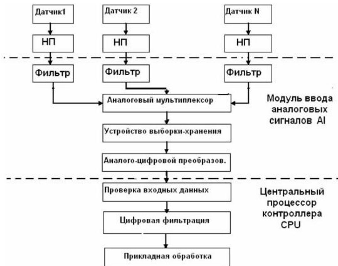
Рис.1.5 Схема обробки аналогового сигналу при введенні в контролер
