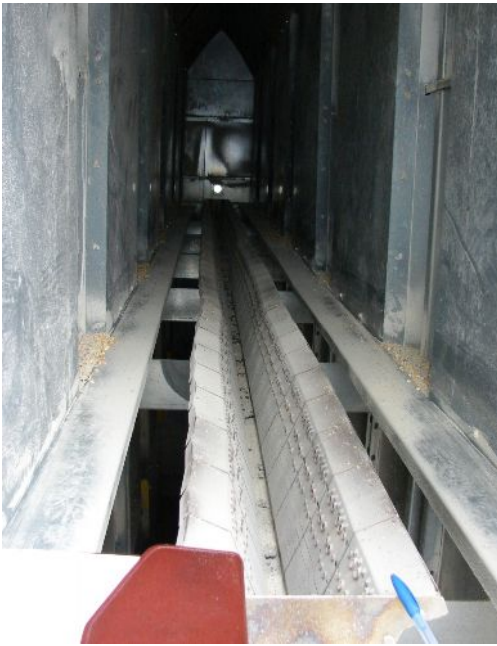
Рис.2. – Зовнішній вигляд та розташування пальника між шахтами зерносушарки GH
