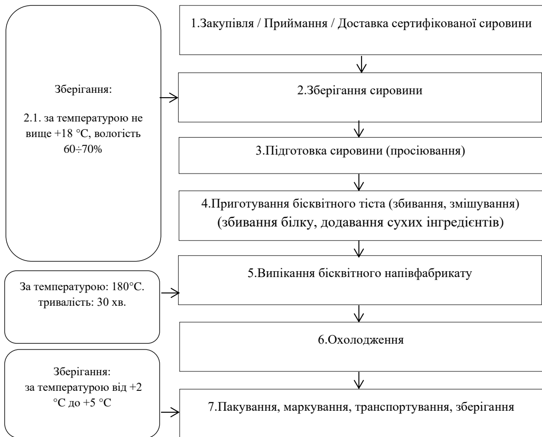
Рисунок 3.1 – Блок-схема виробництва бісквітного напівфабрикату
