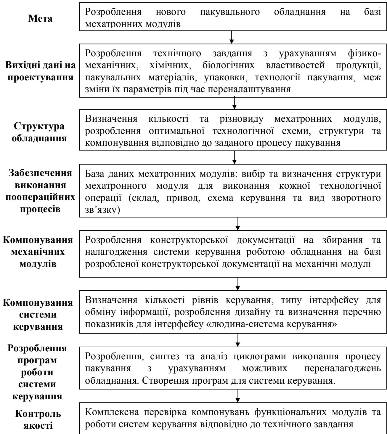
Рис. 1.2 Алгоритм виконання етапів проектування нового пакувального обладнання з мехатронних функціональних модулів
