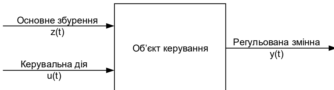
Рис. 7.2. Параметрична схема нагрівника по каналу температури.
