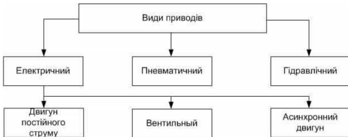
Рисунок 1.3 – Види приводів, що використовуються в маніпуляторах
