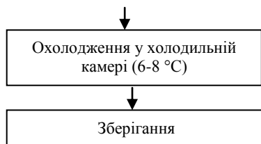
Рис.2 Принципова технологічна схема виробництва кефіру та йогуртів
