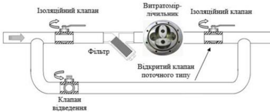
Рис. 3.2.7. Приклад експлуатації витратоміра-лічильника Kobold DOM
