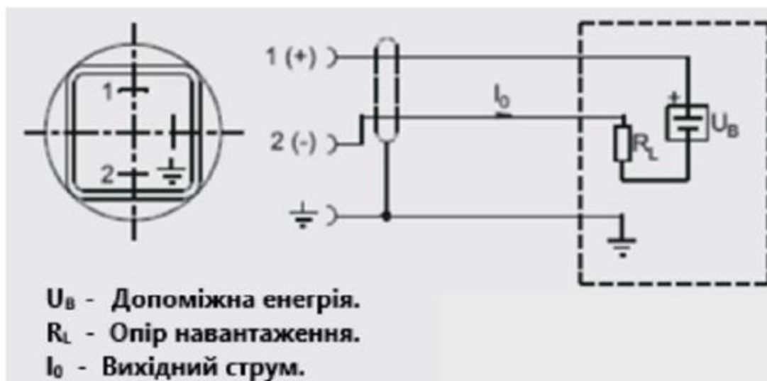
Рис.3.2.13. Схема підключення SITRANS TF2 до двопровідної лінії живлення
