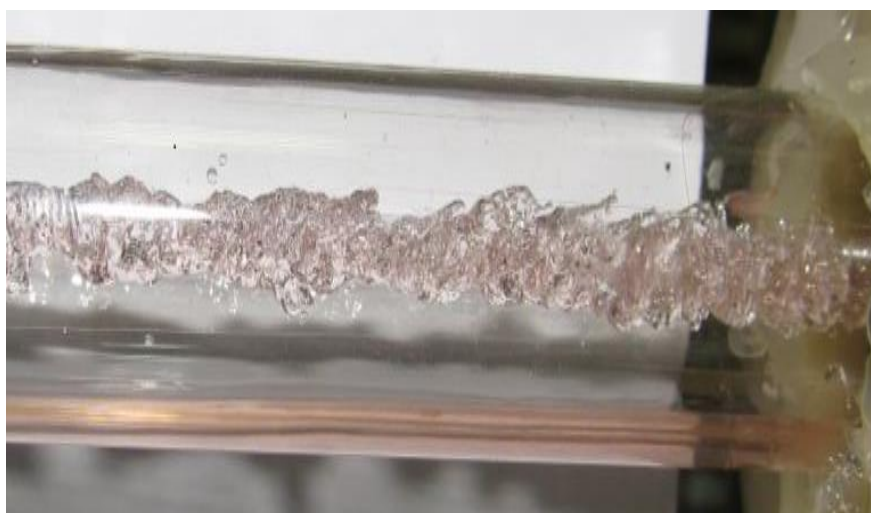
Рис. 3.10. Течія двофазного потоку в камері змішування ежектора з m = 126,5
