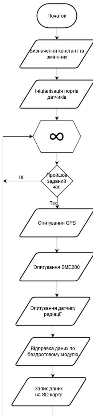
Рис.3.2 Блок схема внутрішньої програми мікроконтролера модуля для збору даних
