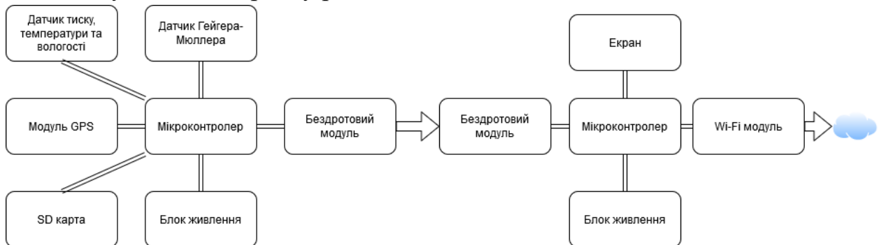
Рис. 2.1 Структурна схема програмно-апаратного комплексу для моніторингу радіаційної обстановки
