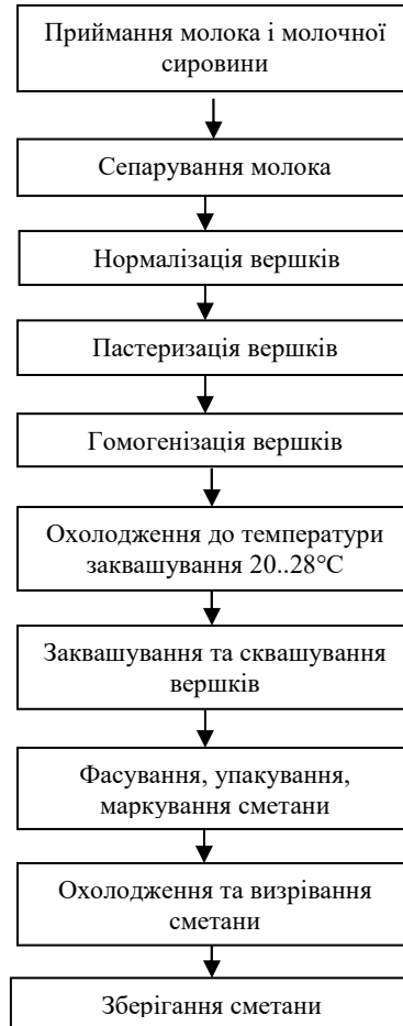
Рис.2 Принципова технологічна схема виробництва сметани резервуарним способом
