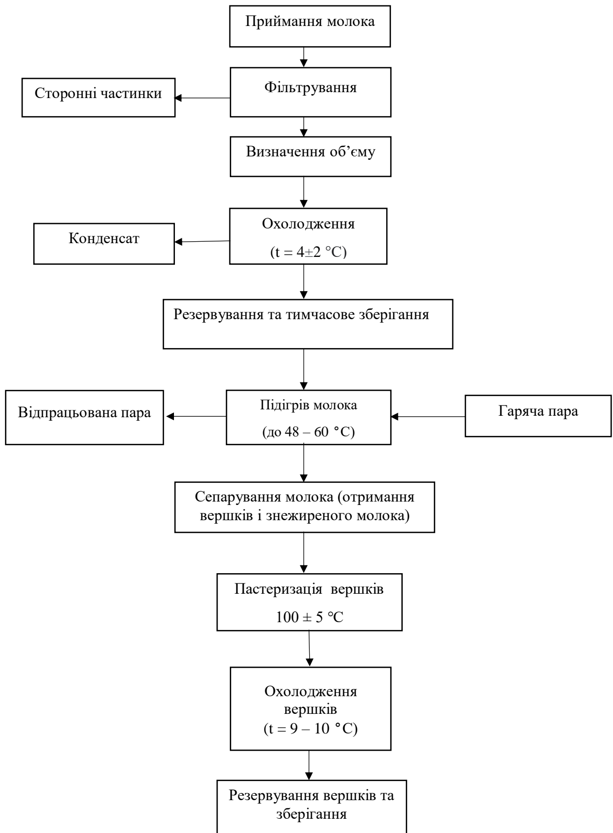
Рис. 2.1. Технологічна схема підготовки молока до виробництва масла солдковершкового
