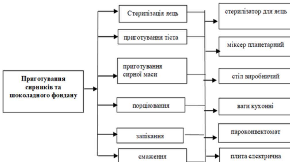
Рисунок 3.6 - Схема технологічного процесу у гарячому цеху
