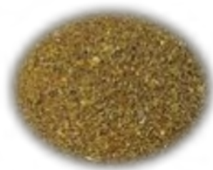
Рис. 3.3 Вигляд каталітичної засипки KDF (Kinetic Degredation Fluxion).
