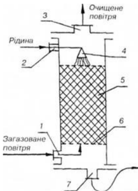
Рис. 10.5. Схема башти-абсорбера: 1 — вхідний патрубок для загазованого повітря; 2 — патрубок для подавання рідини; 3 — вихідний патрубок для відведення очищеного повітря; 4 — розбризкувач; 5 — шар рідини з насадкою; 6 — сітка; 7 — вихідний патрубок для відведення забрудненої
