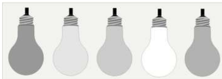
Рисунок 7.4 – Коливання світлового потоку штучних джерел освітлення, викликаних коливаннями напруги
