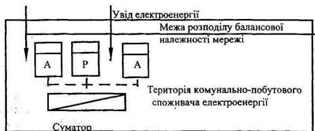
Рис. 6.2. Узагальнена структурна схема організації обліку електроспоживання на комунально-побутовому об'єкті.
