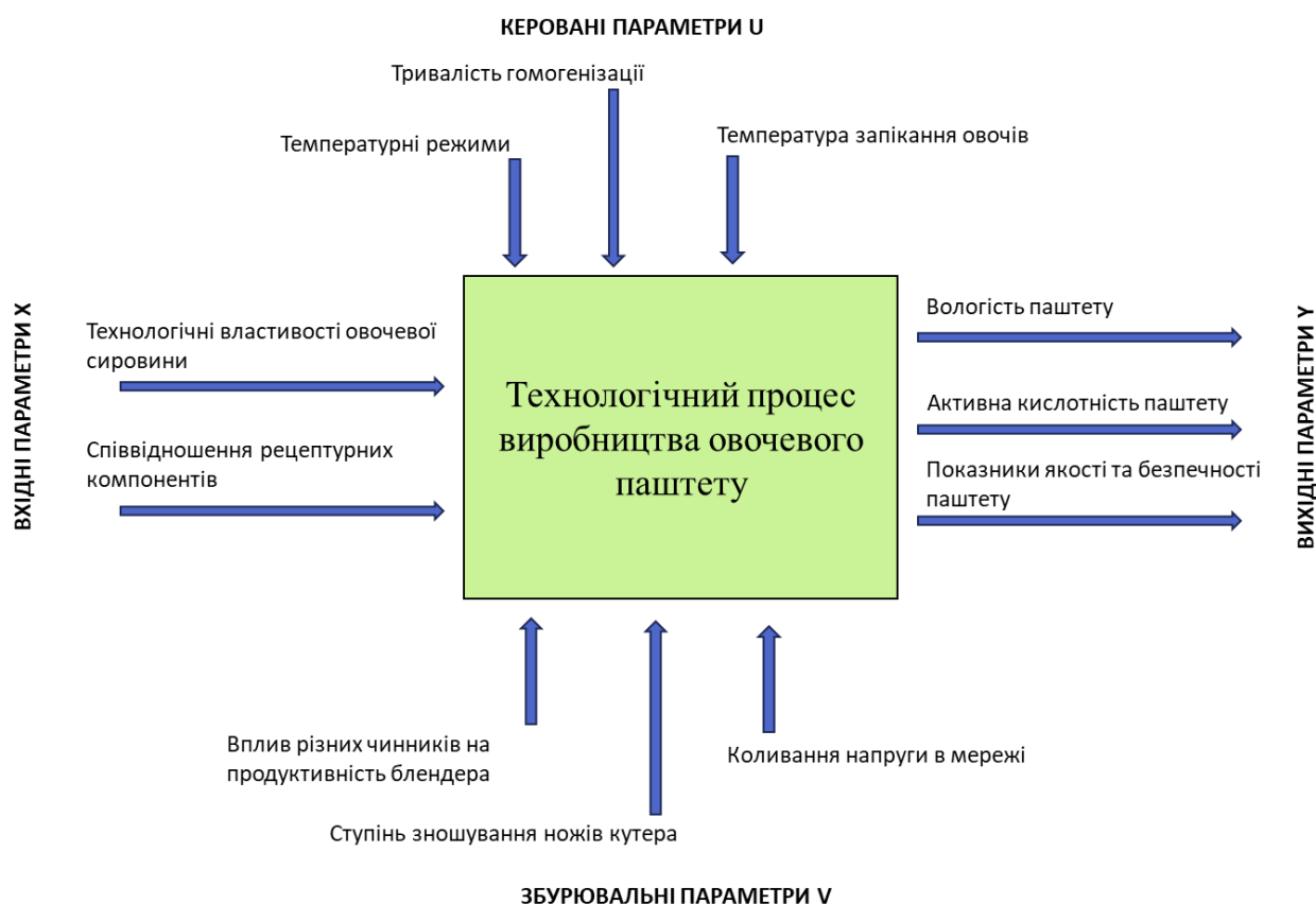
Рис. 2.11 Приклад моделі «чорна скринька» для технології овочевих паштетів
