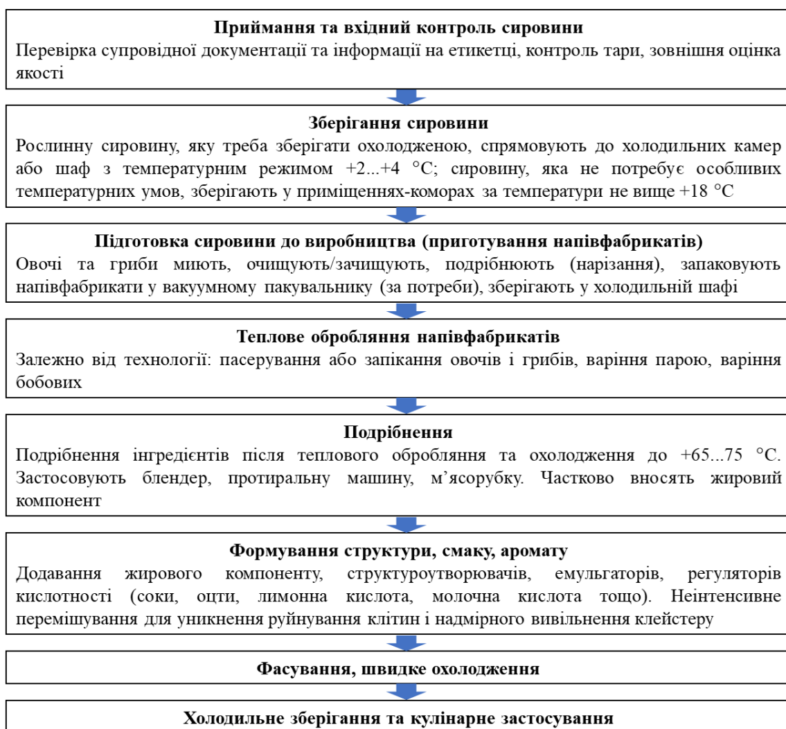
Рис. 1.3 Принципова технологічна схема виробництва овочевих паштетів Джерело: розробка автора
