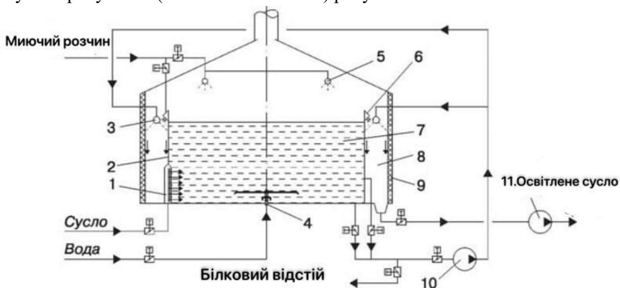
Рис. 2.2. Принципова схема гідроциклонного апарату Calypso конструкції Steinecker: 1 — пристрій для тангенційного введення сусла; 2 — внутрішня оболонка; 3 — колектор для сусла; 4 — промивальник осаду; 5 — мийна головка; 6 — колектор для миття міжстінкового простору; 7 і 8 — зони
