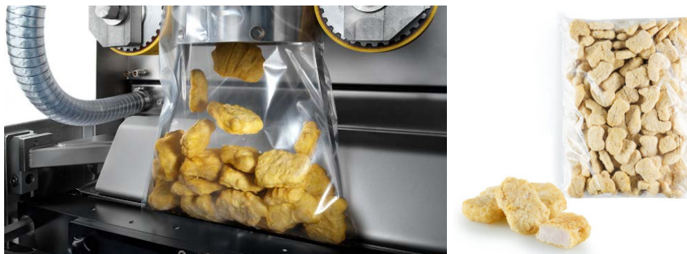
Малюнок 3.25. Пакування нагетсів на Smart Packer
