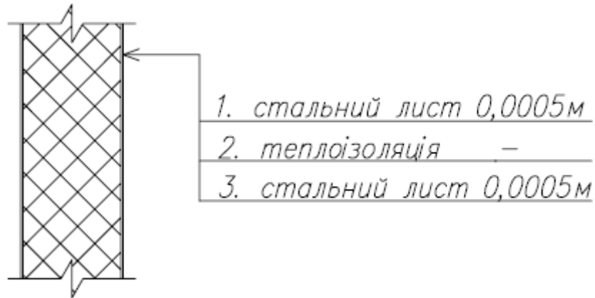
Рис.4.1 Конструкція зовнішньої стінки
