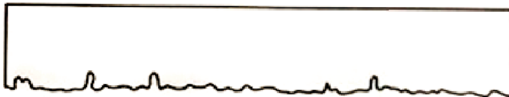
Рисунок 3.3 – Векторна лінія, отримана у Adobe Illustrator Отриману лінію зберігають у форматі .dwg і відкривають у програмі AutoCAD. Тут зображення командою aww аналізується і на екран виводить інформація про нерівності з виведенням всієї інформації про відхилення.
