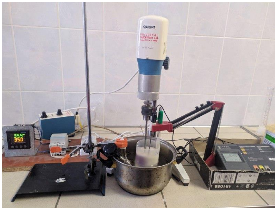
Рис 3.1. Лабораторна установка виробництва E1451
