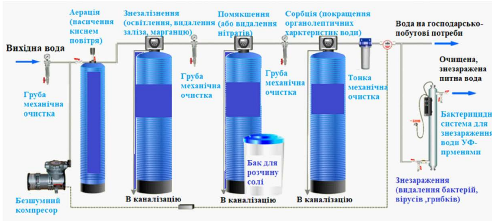
Система очистки води
