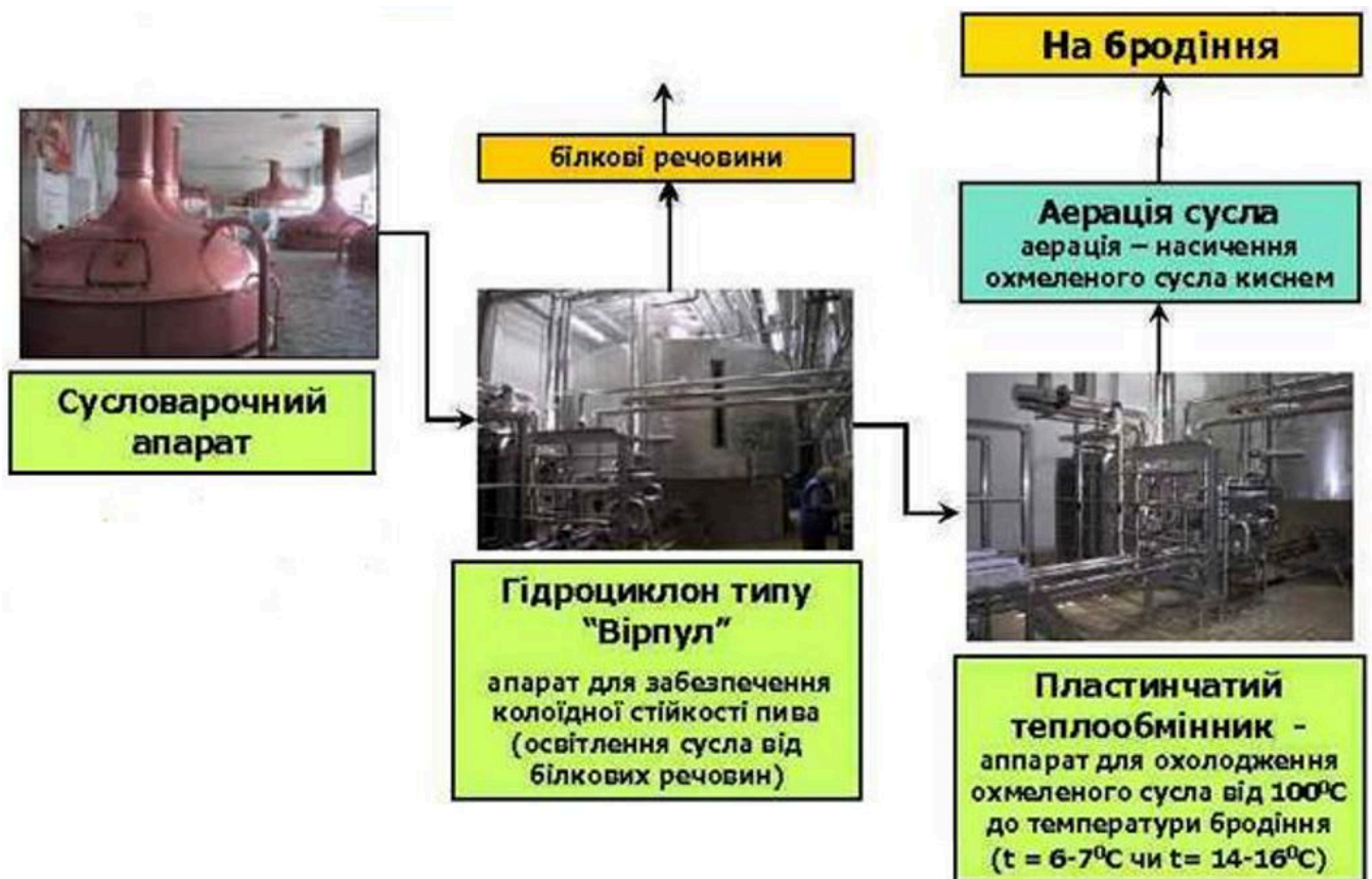
Рис. 1.1. Технологічні процеси з пивним суслом перед бродінням.
