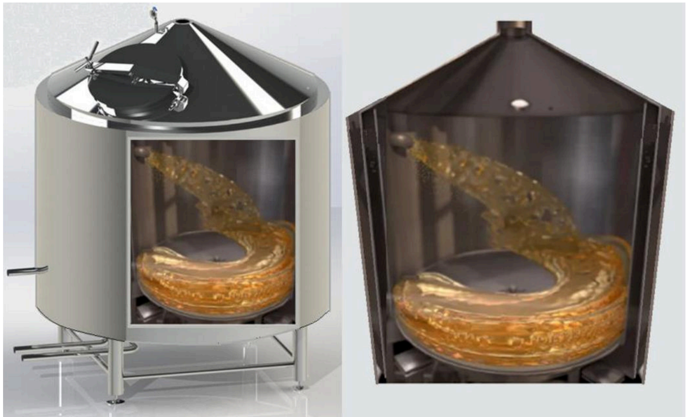
Рис. 1.7. Надходження пивного сусла в гідроциклон.
