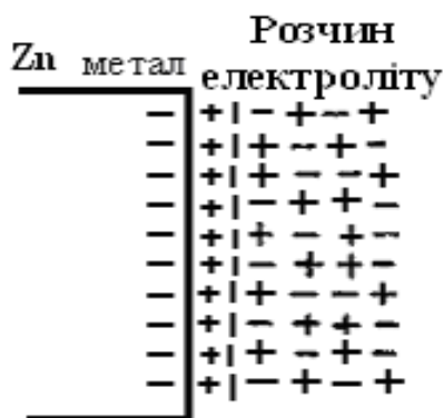
Рис. 2.4. Подвійний електричний шар цинку
