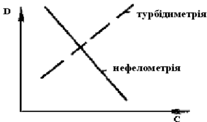
Рис. 3.12. Криві нефелометричного та турбідиметричного титрування
