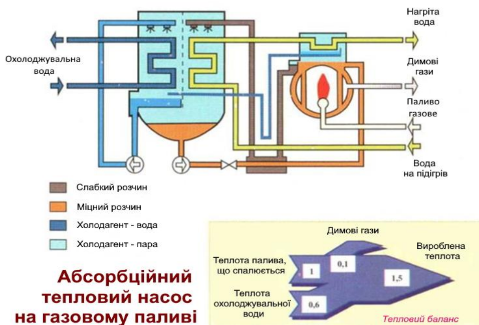
Рис. 1.5. Абсорбційний тепловий насос на газовому паливі
