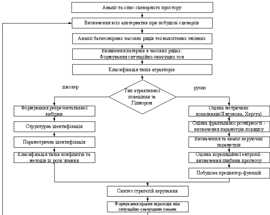
Рис. 2.24. Алгоритм управління станцією дефекосатурації в рамках ситуаційного підходу
