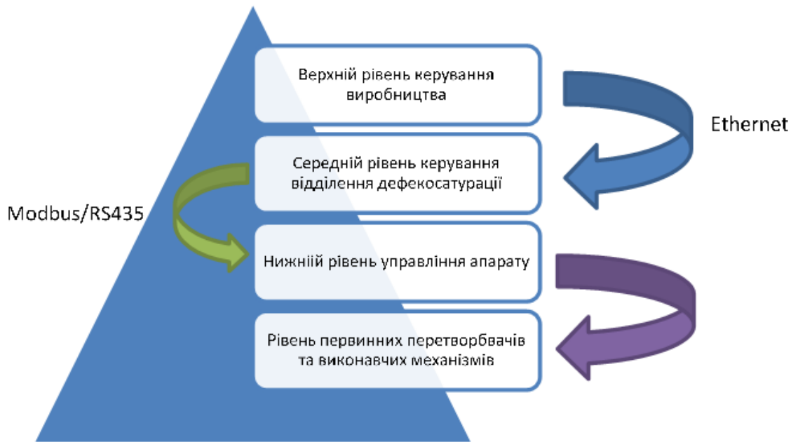
Рисунок 1.7 . Ієрархічна структура технологічного процесу дефекосатурації
