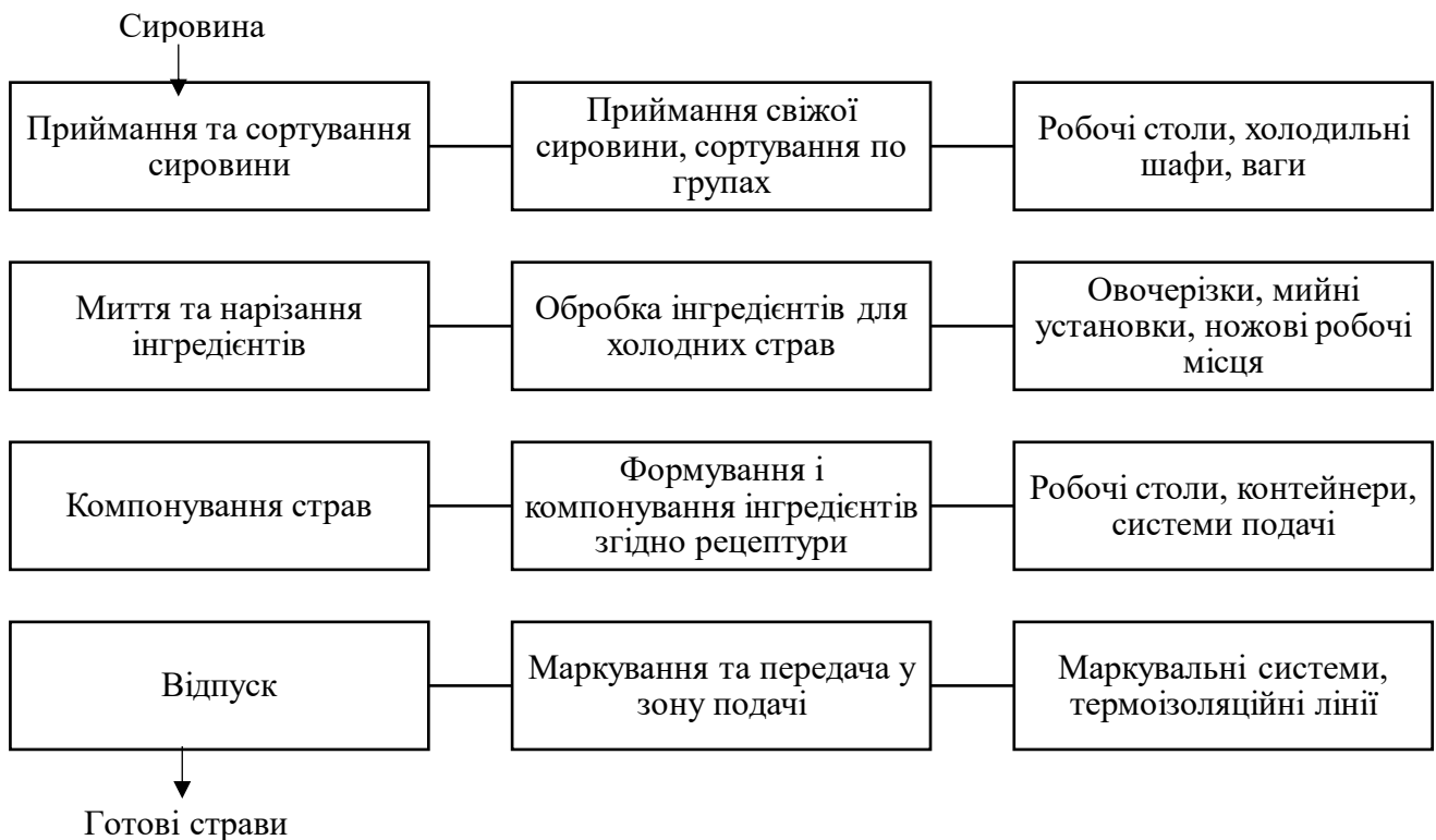
Рис.3.6 – Структурно-технологічна схема виробничого процесу холодної лінії відділення для оформлення та зберігання борошняних виробів
